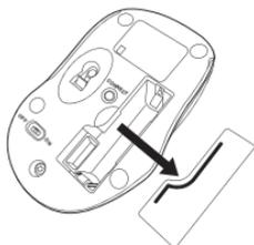
2. Instale la pila AAA, respetando la señal positiva (+) y negativa (-) de polaridad del interior del compartimento.
