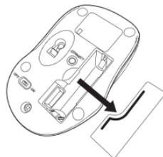
2. Insérez la pile de type AAA, en respectant le sens des polarités positive (+) et négative (-) indiquées à l'intérieur du compartiment de la pile.
