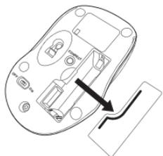
2. Introduza a pilha AAA, certificando-se de que o pólo positivo (+) e o pólo negativo (-) em cada uma das extremidades da pilha coincidem com os indicadores de polaridade no interior do respectivo compartimento.
